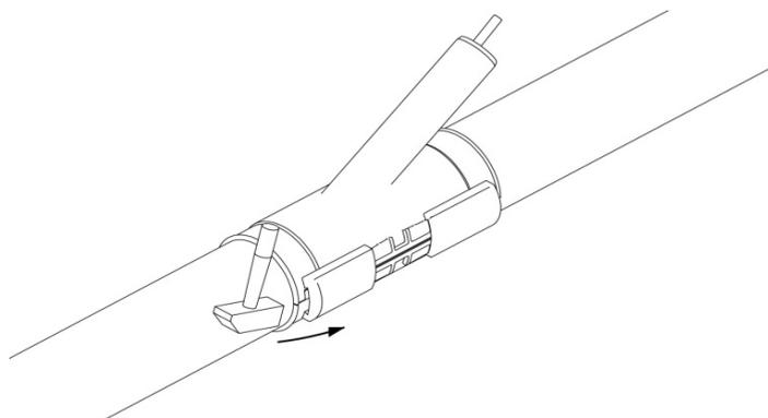
4) Enclencher manuellement les pièces de serrage et fixer les avec le marteau.
