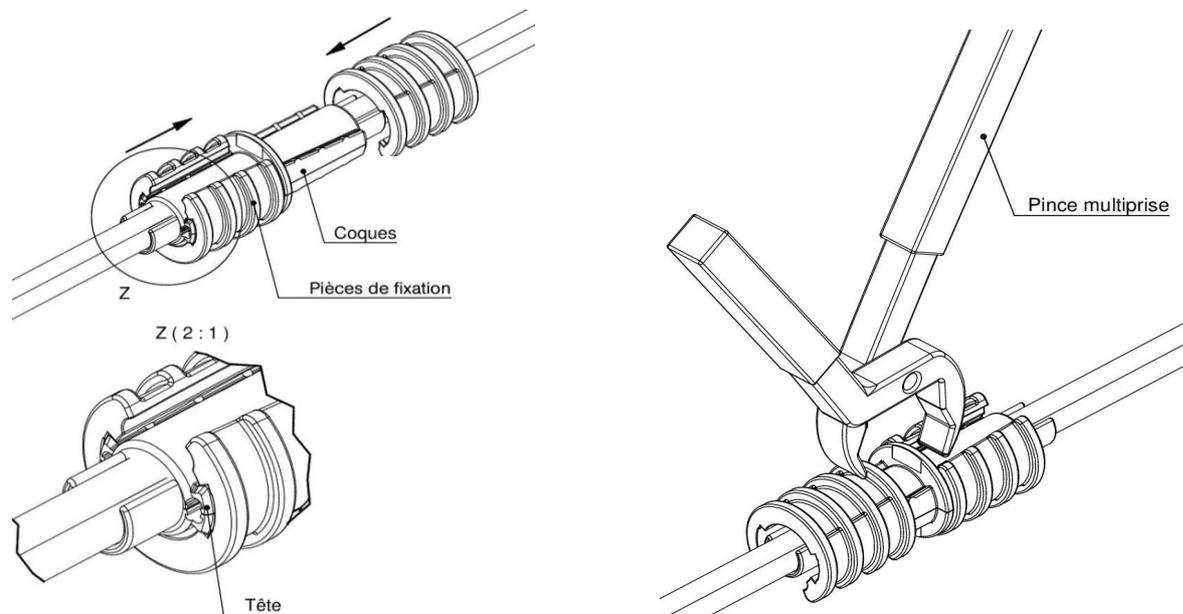
3) Enclencher à la main les pattes de serrage (en respectant le sens indiqué) et les serrer avec une pince multiprise.
